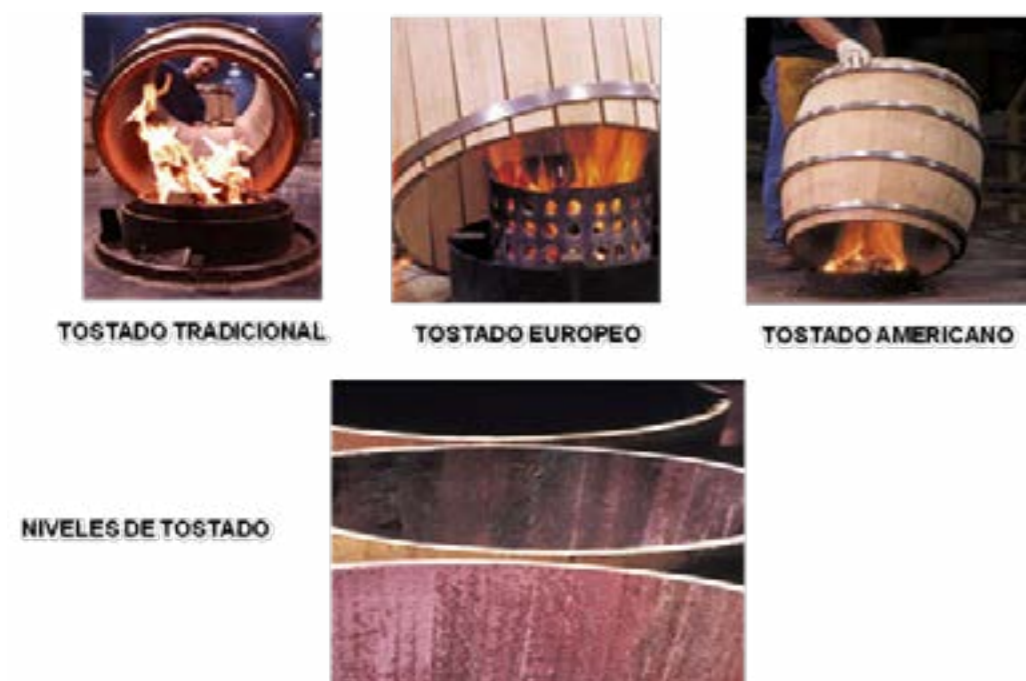
Figura 1.- Ejemplos de los tipos y de los niveles de tostado de una barrica.
