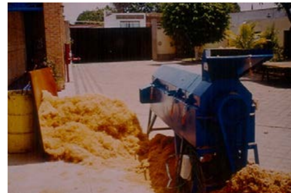
Figura 3. Equipo para la separación física fibra/médula del bagazo de agave.
